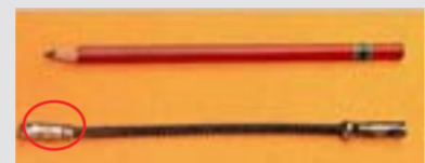
As fontes usadas em radiografia são colocadas dentro de rabichos (porta-fontes). O porta-fonte pode ser do tamanho de um lápis, enquanto que a fonte (marcada com um círculo na figura acima) é menor.
